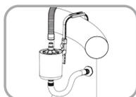
Wanneer u geen muurskimmer heeft: Er zijn 4 verbindingsstukken (**G1/G2/G3/G4**) meegeleverd in het pakket die op zeven hoofdtypen passen (zie onderstaand) die gebruikt worden bij zwembaden met zachte wanden. Selecteer het verbindingsstuk dat overeenkomt met het filter van uw zwembad en verbind deze met het filter. Alleen met de hand vastdraaien.
