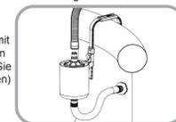
Wenn Sie keinen Skimmer haben: Im Satz sind 4 Verbindungsstücke (**G1/G2/G3/G4**) enthalten die passen auf sieben Hauptfilter, die in weichwändigen Pools benutzt werden. Wählen Sie das Verbindungsstück das zur Filter Ihres Schwimmbad passt und verbinden Sie es mit dem Filter. Nur handfest anziehen.
