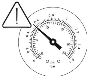
**REMARQUE :** Le manomètre n'est prévu que pour la maintenance et la valeur du manomètre sert uniquement de référence, il ne faut pas l'utiliser comme instrument de précision.
