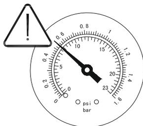
**OPMERKING:** De manometer dient enkel voor onderhoudsdoeleinden en de waarde van de manometer dient enkel ter referentie, het is geen precisietoestel.
