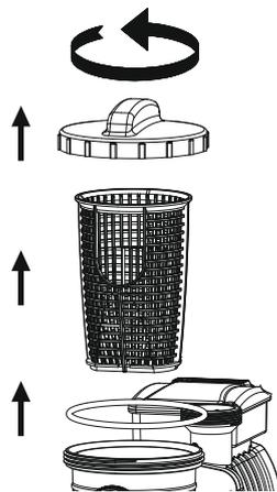
**OPMERKING:** De pompkorf moet periodiek geledigd en gereinigd worden. Een vuile of vastgeslibde pompkorf zal de prestaties van de zandfilter verminderen.
